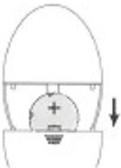
Tout d'abord, tirez la télécommande vers le bas et insérez la pile dans son logement en veillant à ce que la borne positive soit orientée vers le haut ; puis, refermez la télécommande.
